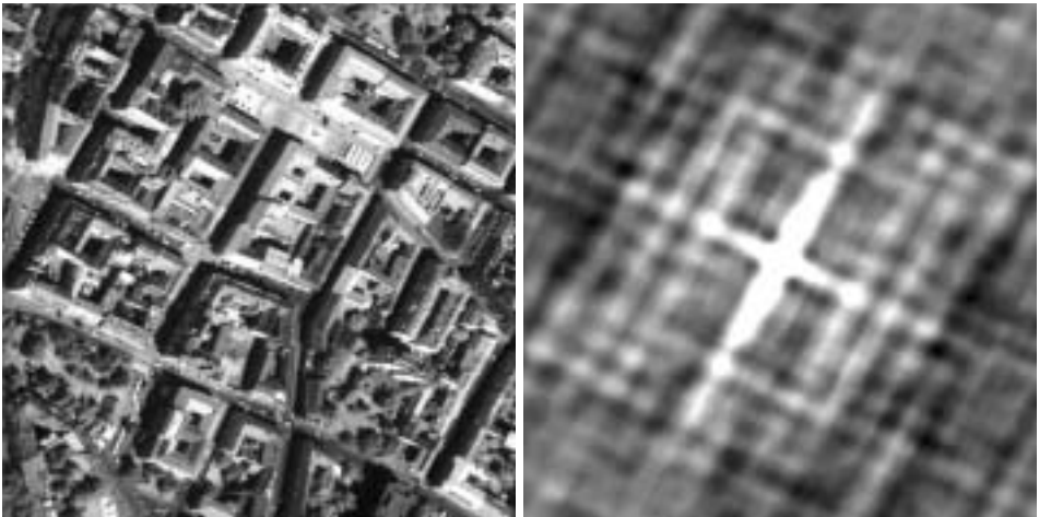
2. ábra IKONOS pankromatikus űrfelvételből készített belvárosi kivágat és autokorrelációs képe Figure 2 Subset of a panchromatic IKONOS satellite image for downtown of Szeged and its autocorrelation image
