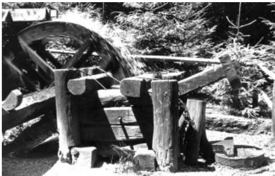
2. kép Felülcsapó – kalapácsot működtető – vízimalom, Szilvásvárad, Erdei Múzeum (fotó: FRISNYÁK S.) Photo 2 Overshot water wheel operating a hammer in the Forest Museum of Szilvásvárad
