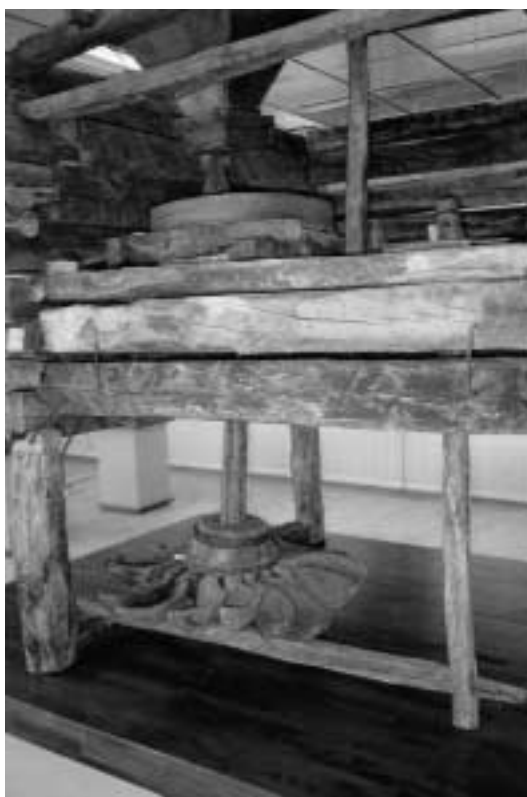
2. kép Felülcsapó – kalapácsot működtető – vízimalom, Szilvásvárad, Erdei Múzeum (fotó: FRISNYÁK S.) Photo 2 Overshot water wheel operating a hammer in the Forest Museum of Szilvásvárad
