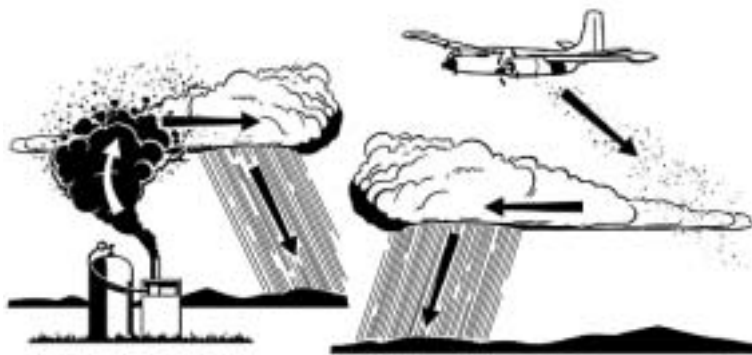
2. ábra. Időjárás-módosítás. Jégképző magvak felhőkbe juttatása történhet talajfelszínen működő generátorokról, repülőgépekről vagy rakétákkal (nem látható). (www.answers.com/topic/cloud-seeding) Figure 2 Weather modification. Cloud seeding can be done by ground generator, plane or racket (not shown). (www.answers.com/topic/cloud-seeding)
