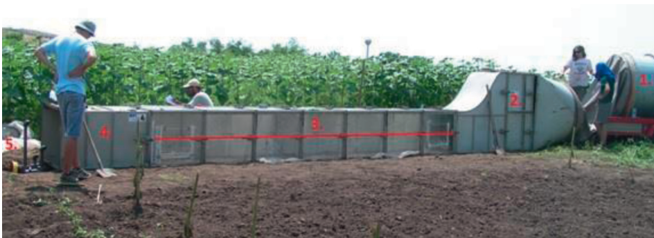
2. ábra Szélcsatorna (részei: 1. turbina, 2. laminátor, 3. szélcsatorna elemek, 4. szediment tálca, 5. szélcsatorna kimeneti nyílása, csapdázók területe)
